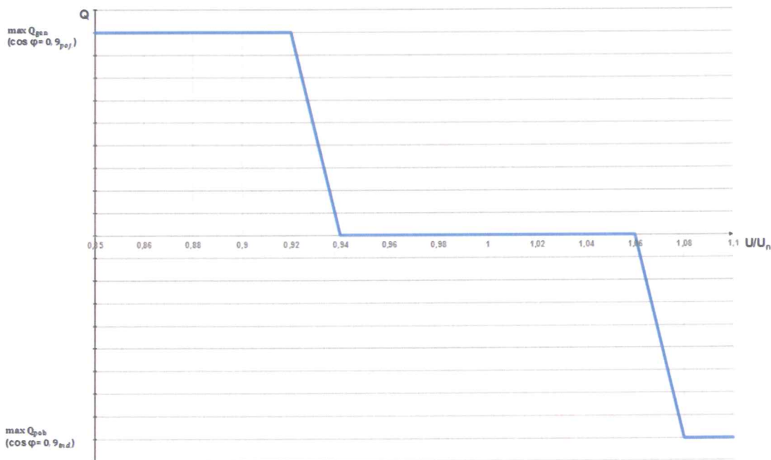
Rys. 3. Charakterystyka sterowania mocą bierną w funkcji napięcia wymagana przez PGE Dystrybucja S.A.
