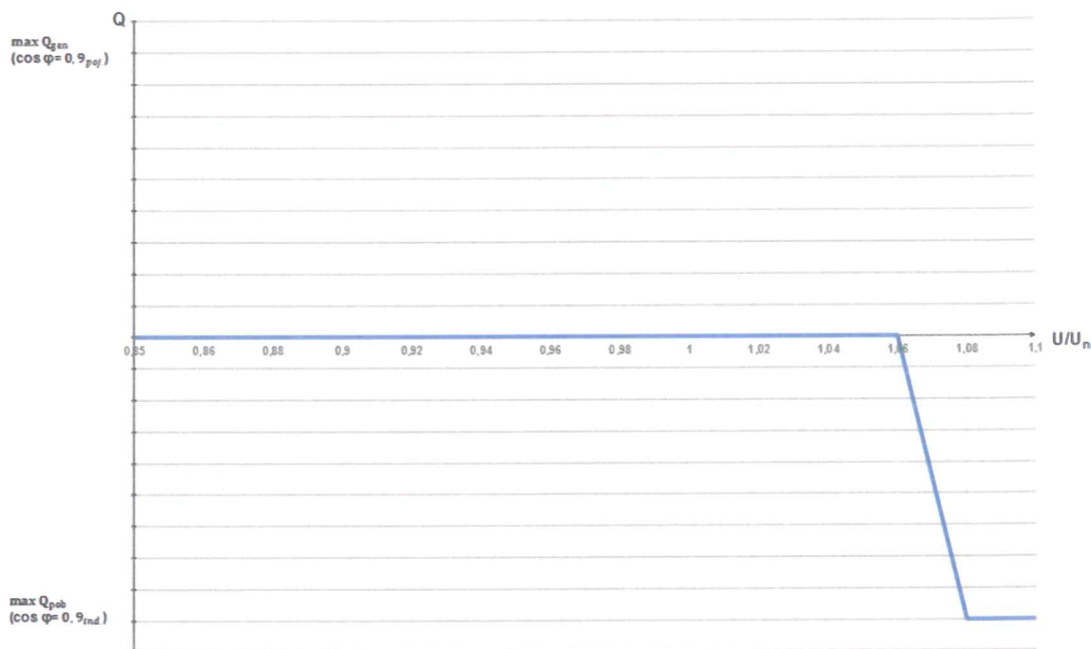
Rys. 4. Charakterystyka sterowania mocą bierną w funkcji napięcia dla falowników podłączonych jednofazowo, wymagana przez PGE Dystrybucja S.A.
